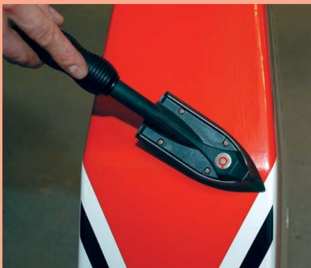
2) En utilisant un fer à soler et un chiffon doux, "repassez" délicatement et "suivez" en appliquant le film avec le chiffon. Si des bulles apparaissent, votre fer est peut être trop chaud. Réduire la température et travaillez doucement et patiemment.
