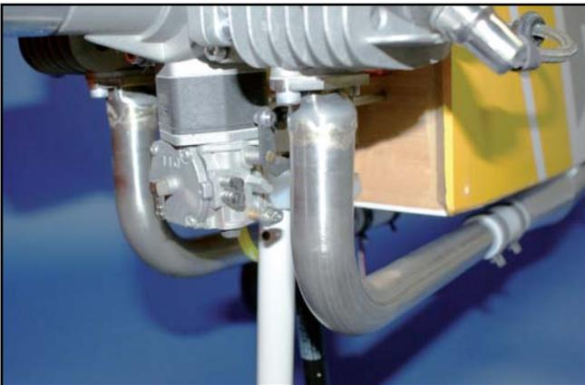
10) Monter les échappements. Nous utilisons des pipes en L KS, que nous coupons à la bonne longueur et avec un angle (pour que le réso passe sous le ventre de l'avion) puis brasons une bride.
