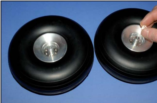
2) Nous utilisons des roues ECOTOP Ø152mm #066WR600 sur le train principal et Ø127mm #066WR500 à l'avant (non fournies). Il est nécessaire de les baguer avec les paliers plastiques livrés avec les roues.
