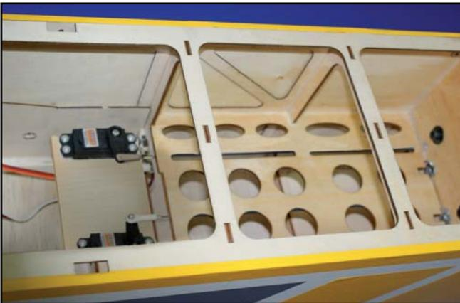
5) Passer la tringlerie dans le fuselage et la connecter au servo des gaz.
