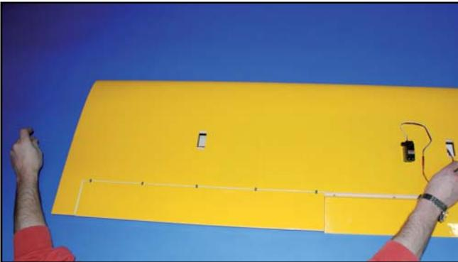
5) Passer les câbles des servos dans l'aile en les tirant avec les cordelettes déjà passées dans l'aile.
