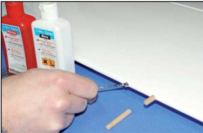
2) Coller à la colle époxy 5mn, les tétons A de fixation du stab. Les trous sont déjà pré-perçés à l'usine.
