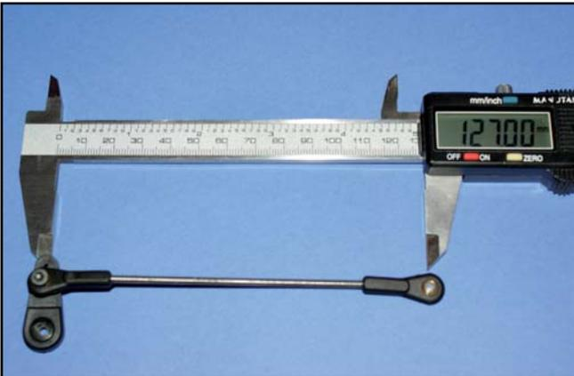
11) Assembler les tringleries de profondeur C comme sur la photo. Régler les chapes pour obtenir la longueur de 127mm.
