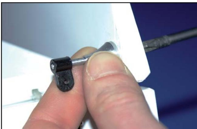
17) Fixer le guignol de direction I en place. Le trou est déjà pré-percé dans le volet de dérive.
