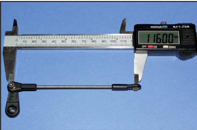
19) Assembler la tringlerie de volet comme sur la photo. Régler les chapes pour obtenir la longueur de 116mm.
