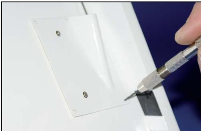
15) Monter la trappe en place dans le stab. Puis percer les 4 trous pour sa fixation dans le stab.
