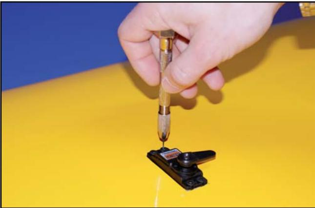
7) Présenter le servo d'aileron. Pré-percer Ø1mm 4 trous pour sa fixation.
