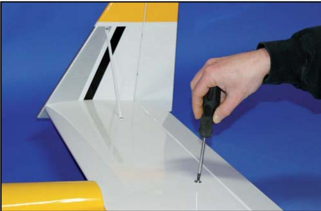
7) Monter le stab. sur le fuselage (tétrons à l'avant+vis à l'arrière).
