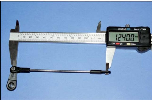
16) Assembler la tringlerie d'aileron B comme sur la photo. Régler les chapes pour obtenir la longueur de 124mm.
