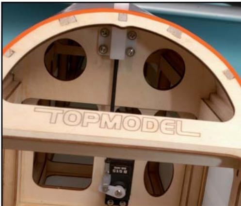
1) Monter le servo du crochet de remorquage et le crochet dans leur emplacement, dans la position montrée sur la photo.
