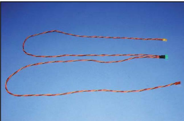
21) Confectionner une rallonge double d'environ 100cm de long qui ira de la prise femelle MG6 des servos de direction à l'arrière du fuselage jusqu'au récepteur à l'avant du fuselage.
