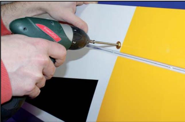
13) Après avoir repéré le trou percé à l'usine pour le guignol d'aileron, percer l'entoilage puis visser la vis sans oublier d'enfiler la rondelle d'appui spéciale comme montré sur la photo.
