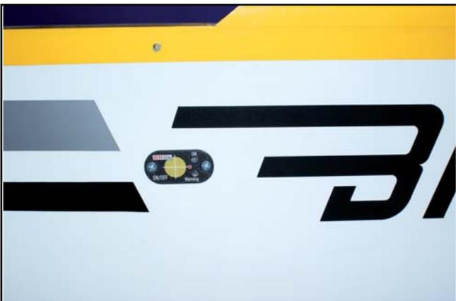
3) L'interrupteur radio magnétique de la JETI MAX BEC est fixé sur le flanc gauche du fuselage.
