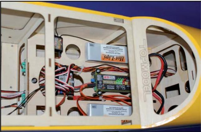
1) En fonction du centrage, installer le régulateur-douleur d'accus JETI MAX BEC 2D, le récepteur et les accus de réception.
