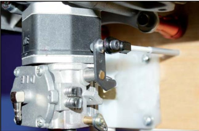
6) Connecter la tringlerie sur le levier des gaz sur le carburateur (penser à déconnecter le ressort de rappel).
