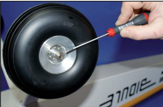
5) Monter les roues (bague d'arrêt de chaque côté).
