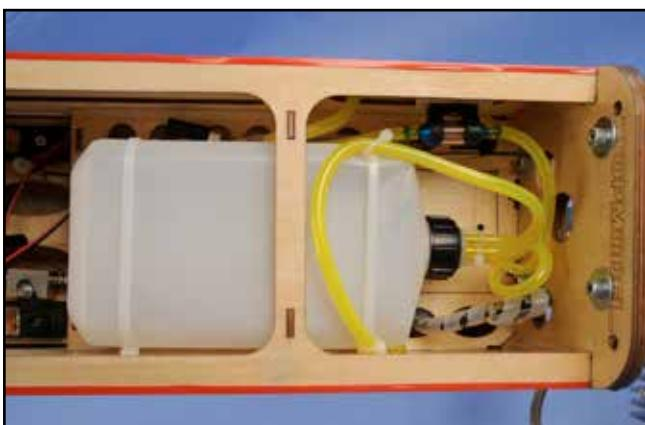
7) ... assemblez le réservoir et le fixer à l'aide de tie-raps.
