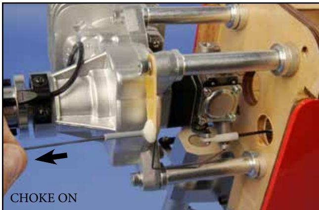
4) ...et là en position fermée, la commande étant accessible par une des ouies d'entrée d'air du capot.
