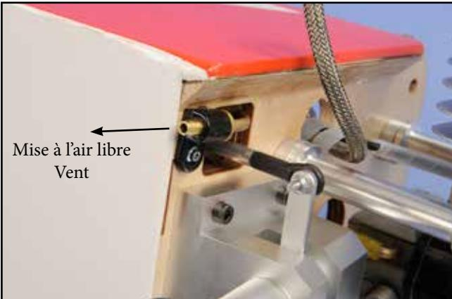
8) Le trop plein/mise à l'air libre a été réalisé à l'aide d'un passage de cloison pour réservoir auquel aura été soudé un tube laiton et un écrou nylon de fixation d'aile, une solution parmi d'autres...
