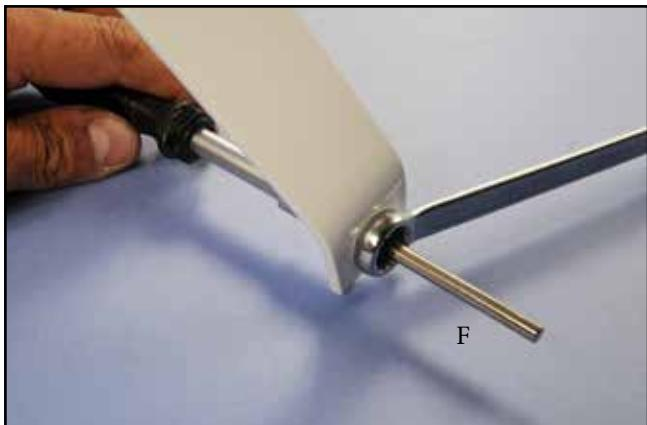
3) A la lime, faire des méplats sur les axes de roue à l'endroit où les vis des butées de roue sont vissées.
