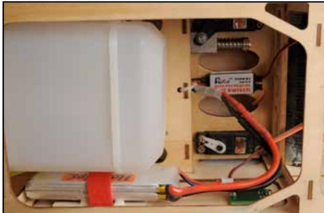
2) L'accu d'allumage est fixé à l'aide de Velcro® et d'une sangle sur le côté du réservoir.
