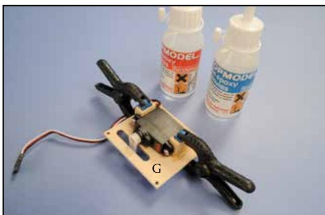
6) Collez le servo sur la trappe à la colle époxy, palonnier parfaitement centré dans l'ouverture.
