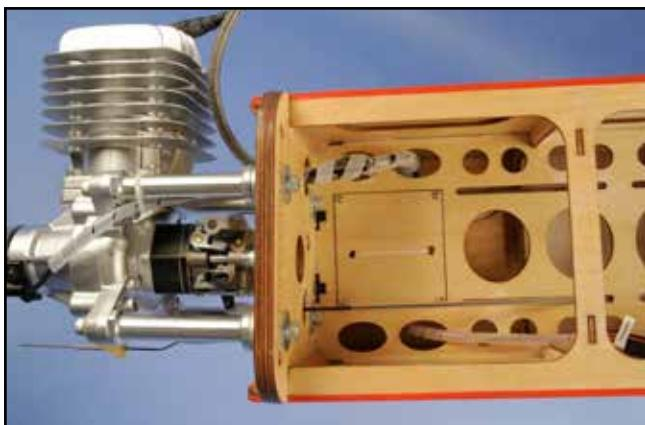
6) Remontez la trappe dans le fuselage, faire passer le cablage bougie, protégé par de la gaine spirale, à travers la cloison pare-feu puis ...
