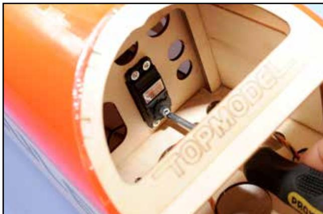
1) Montez le servo de crochet de remorquage et le crochet dans leur emplacement respectif, dans la position montré sur cette photo.
