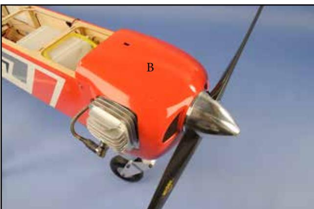
11) Découpez et ajustez le capot moteur puis montez cône et hélice.
