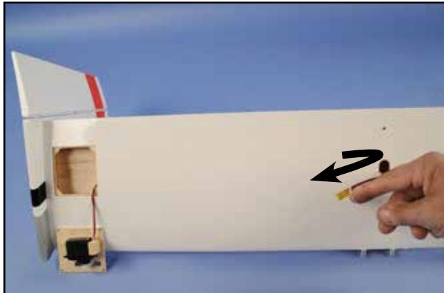
8) Enfilez les rallonges de servo dans le stab à l'aide des ficelles déjà posées en usine.
