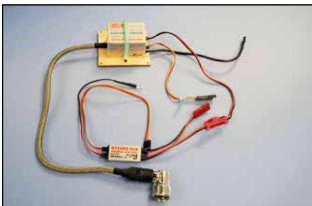
5) Connectez le kill switch à l'allumage, lui-même fixé (à l'aide d'un tie-rap enfilé dans un bout de durit) à la trappe qui se situe juste derrière la cloison pare-feu dans le fuselage.
