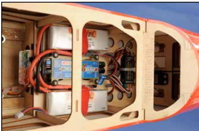
1) Installation radio : la position des accus est déterminée par le centre de gravité.
