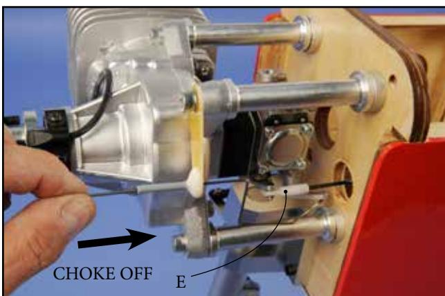
3) Puis raccordez au levier de commande du carburateur avec la chape à rotule E (pensez à déconnecter le ressort de rappel).
