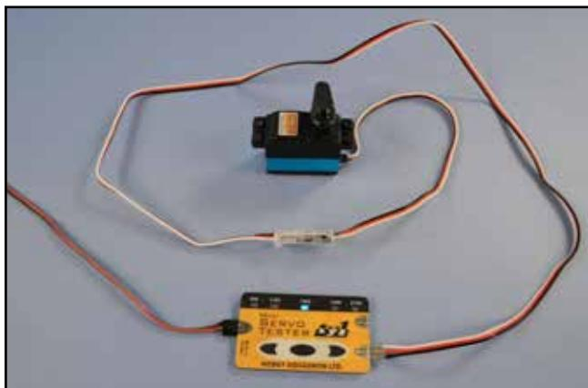
12) Connectez une rallonge de 70cm au servo de profondeur puis assurer avec une sécurité de connecteur #0434085. Le mettre au neutre à l'aide d'un servo tester #0435051.
