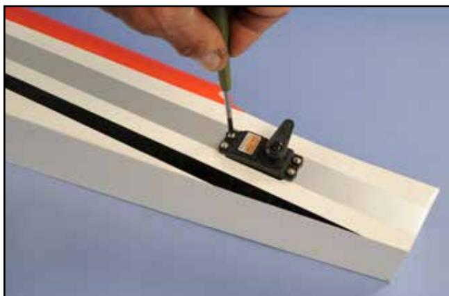
13) Montez le servo profondeur dans son emplacement à l'arrière du fuselage.
