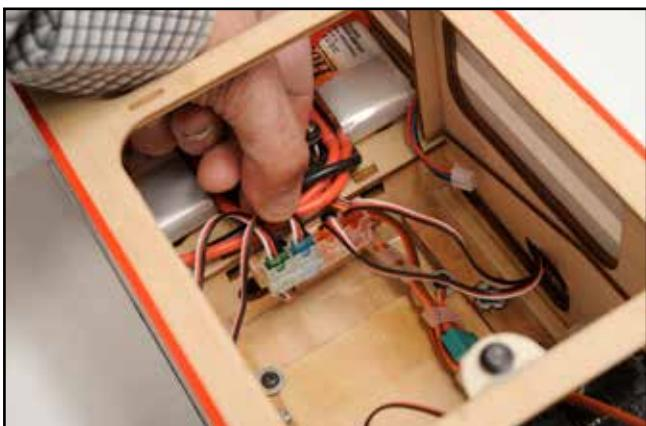
3) Devant le régulateur de tension JETI MAX BEC, le terminal de connection prêt à accueillir les rallonges d'aile.
