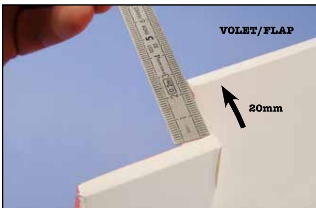
11) ... servo au neutre (bras braqué à 20°), le volet doit baisser de 20mm (1er cran de volet).
