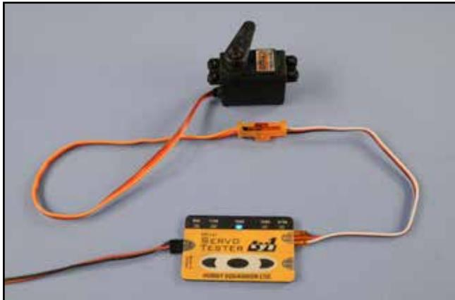
8) Connectez une rallonge de 20 cm au servo de volet puis assurer avec une sécurité de connecteur #0434085. Le mettre au neutre à l'aide d'un servo tester #0435051, palonnier orienté de 20° vers le bord de fuite de l'aile.
