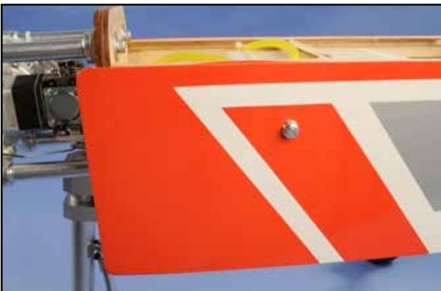
9) Sur le flanc du fuselage, à l'intérieur le filtre à carburant #0432047 et à l'extérieur le système de remplissage F3A #0432028.
