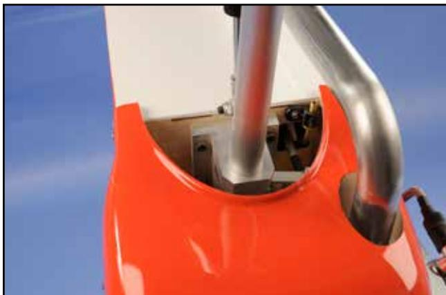
13) La lèvre sous le capot doit être découpée de cette façon. Elle participe à l'extraction de l'air chaud sous le capot pour améliorer le refroidissement du moteur!
