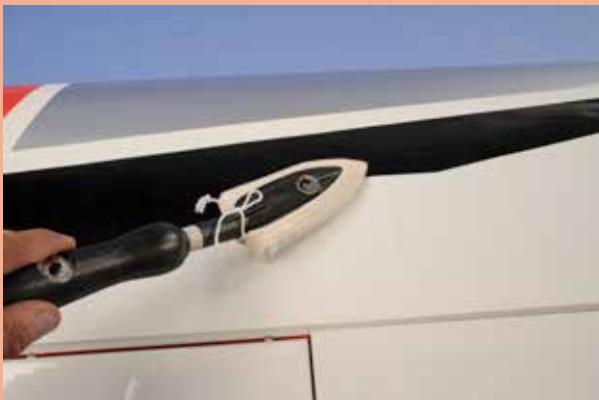
2) En utilisant un fer à soler et un chiffon doux, "repassez" délicatement et "suivez" en appliquant le film avec le chiffon. Si des bulles apparaissent, votre fer est peut être trop chaud. Réduire la température et travaillez doucement et patiemment.
