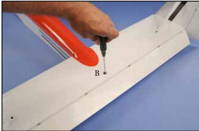
16) Montez le stab sur le fuselage (M4x35mm + rondelle).
